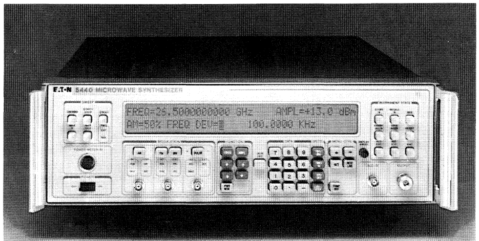
Fig. 1: Synthétiseur modèle EATON 5443 (1 MHz - 26 GHz).
